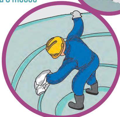
2. Cepillar los pisos, paredes y techos con escobillas de cerdas plásticas duras (gruesas) para evitar rayar las paredes del tanque cisterna.
