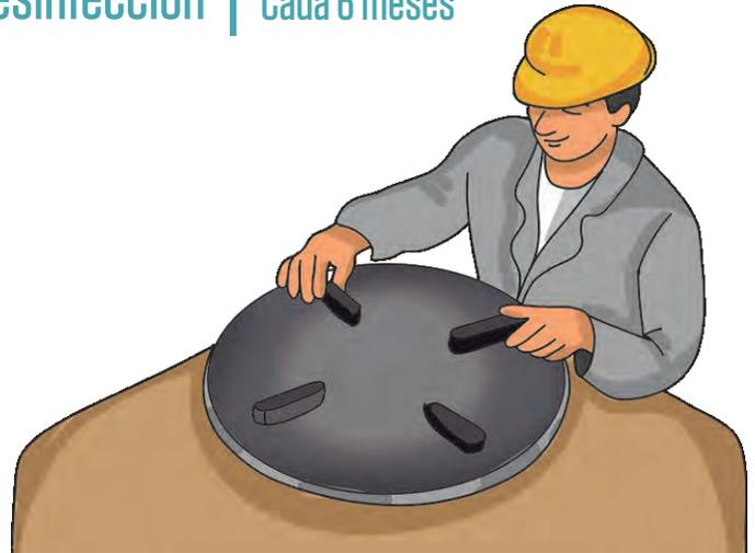
2. Proceder a desenroscar y retirar la tapa del tanque. Abrir la válvula de limpieza (vaciado). El agua que queda hay que eliminarla totalmente con un trapo y dejar el tanque completamente limpio.
