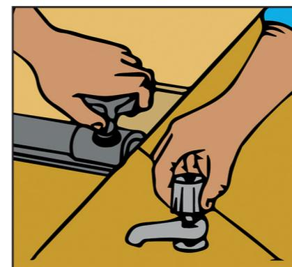
Corte el agua cerrando la llave de paso. Purgar el agua que todavía queda en la tubería abriendo el caño totalmente.
